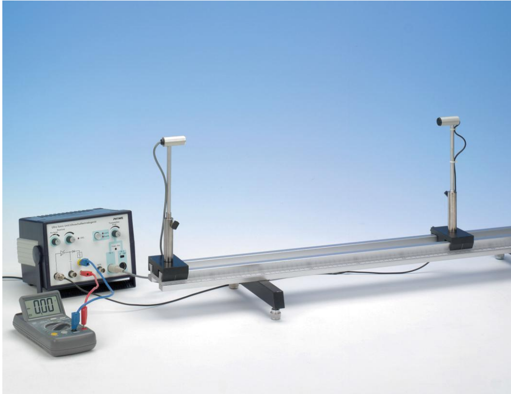
Rys.1. Zestaw pomiarowy do sprawdzania prawa absorpcji ultradźwięków w powietrzu.
